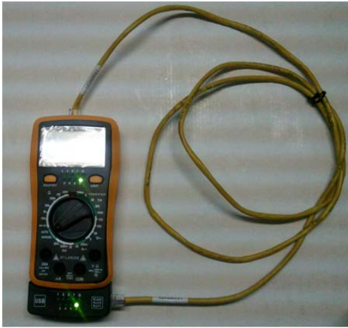
PRUEBA 1. PRUEBA DE CABLE DE RED EN MODO TESTER CON CONECTOR RJ45, INDICADOR LED DE CORRECTA CONEXION.
