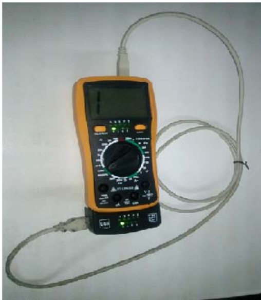
PRUEBA 3. CABLE USB "A" - USB "B" EN MODO TESTER AUTOMATICO INDICADOR DE LED CORRECTA CONEXION.
