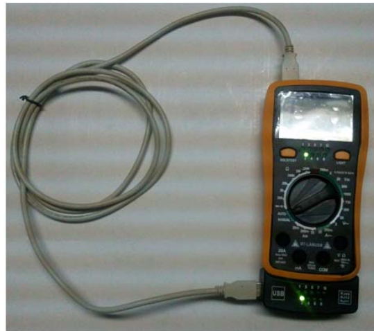
PRUEBA 2. CABLE USB TIPO "A" - "A" EN MODO TESTER AUTOMATICO INDICADOR LED DE CORRECTA CONEXION.
