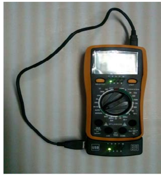
PRUEBA 4. CONEXION USB "A" - MINI USB, EN MODO TESTER AUTOMATICO, LED INDICADOR DE CORRECTA CONEXION.
